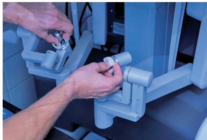
Abb. 2: Fingerschlaufen zur Steuerung der Roboterarme und Instrumente
