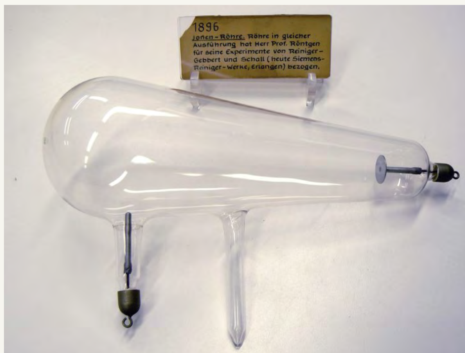
Ionenröhre, mit der Röntgen seine Entdeckung machte
